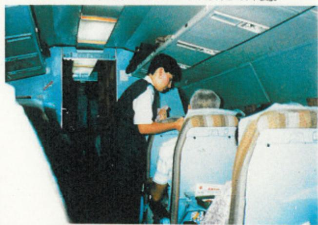
►Tu-134の機内。シートは西側機に比べ簡素で、このクラスの中距離機のキャビンはフタのついたストウェージ式でなくご覧の通りのハットラック式だ。
