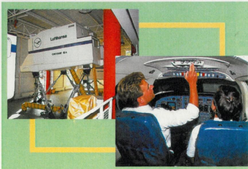
左はバイバー・シャイアンIII Aのフライトシミュレーター（約6000万マルク。6軸のモーション、ビジュアル・システム付き）。右は同じくシャイアンIII AのCPT（操縦手順訓練機）。
