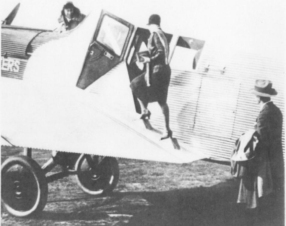
世界初の全金属製で、独立した客室を持った飛行機ユンカースF13
